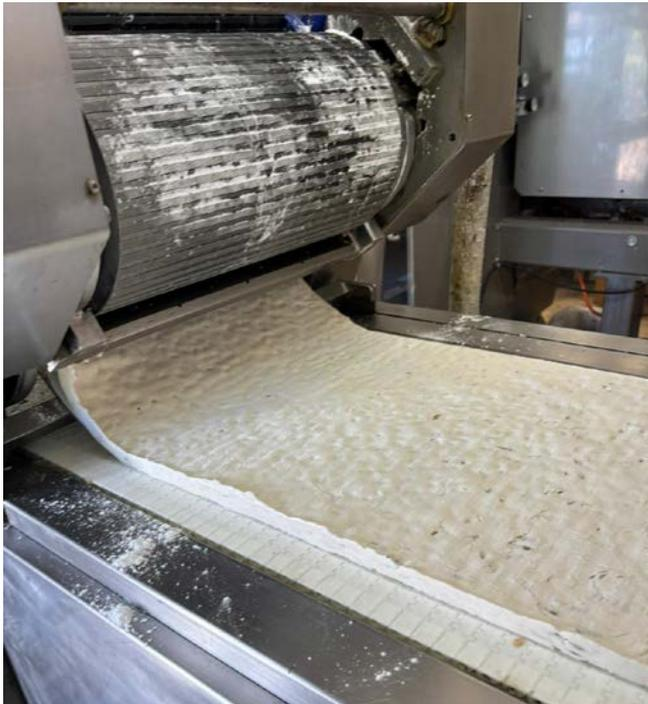
Nougat à la sortie du laminoir, il passe dans un tunnel de refroidissement pour être tranché
